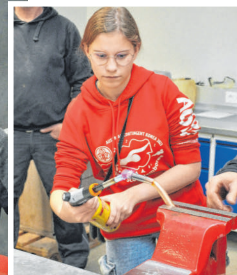
Der Unterschied zwischen Hart- und Weichlöten besteht in der Löttemperatur.
